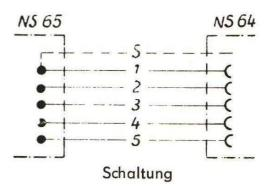
Mikrofonanschlußkabel C 56
